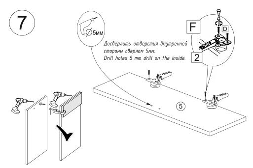
**ВНИМАНИЕ!!!** Во избежании повреждений фасада, при досверливании отверстий под ручку, используйте подложку, зафиксировав ее с лицевой стороны фасада. To avoid damage to the facade when drilling holes under the handle, use a substrate, fixing it on the front side of the facade.
