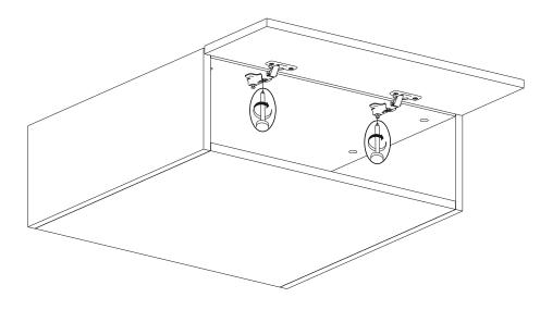
Регулировка петель/Sash loop adjustment
