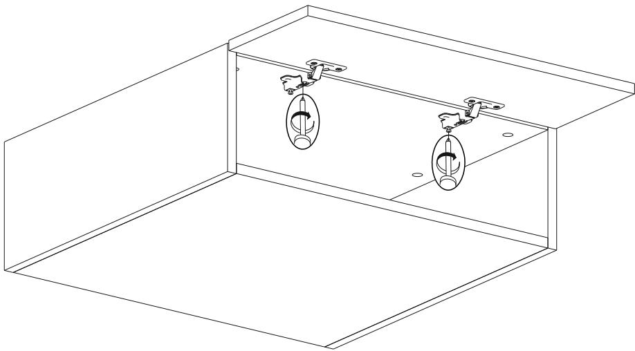
*Регулировка петель / Sash loop adjustment*
